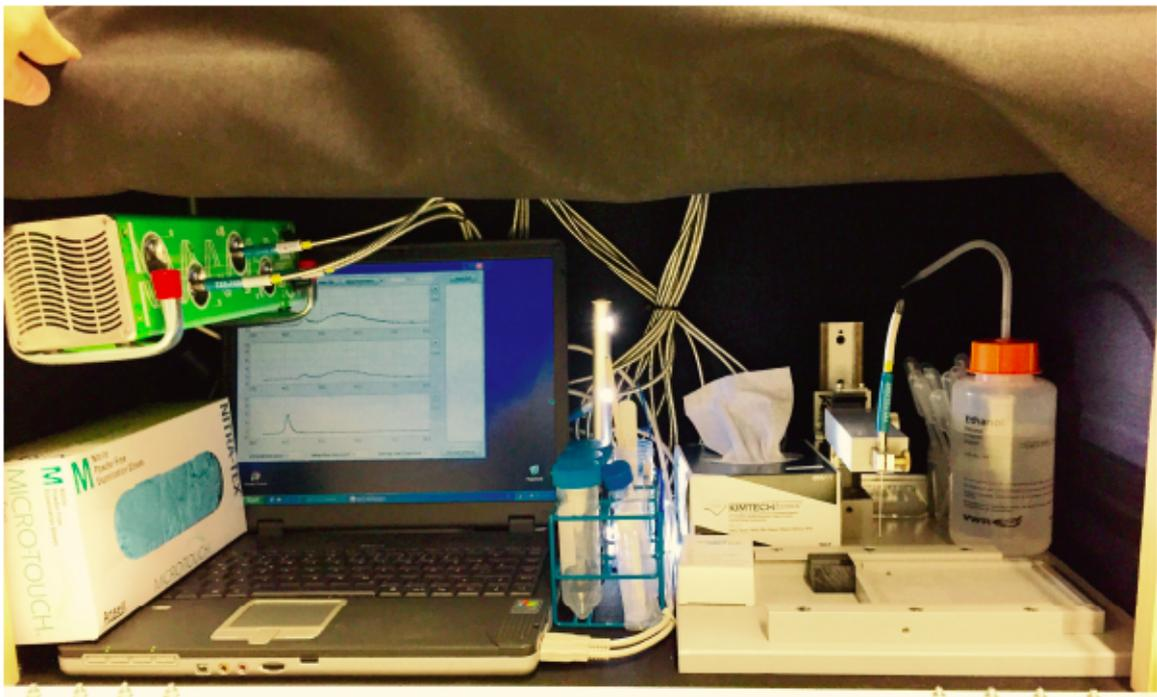
**Abb. 3: Mini-Spektrometer mit angeschlossener Faseroptik installiert in einer Dunkelkammer**
