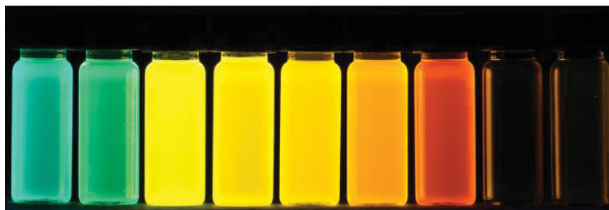
Abbildung 24: Fluoreszenz der Verbindung 4t in neun Lösungsmitteln unterschiedlicher Polarität (von links nach rechts: n -Pentan, Cyclohexan, Toluol, 1,4-Dioxan, Diethylether, Ethylacetat, Dichlormethan, N,N -Dimethylformamid, Acetonitril; \lambda_{\text{exc}} = 365 \text{ nm} ).
