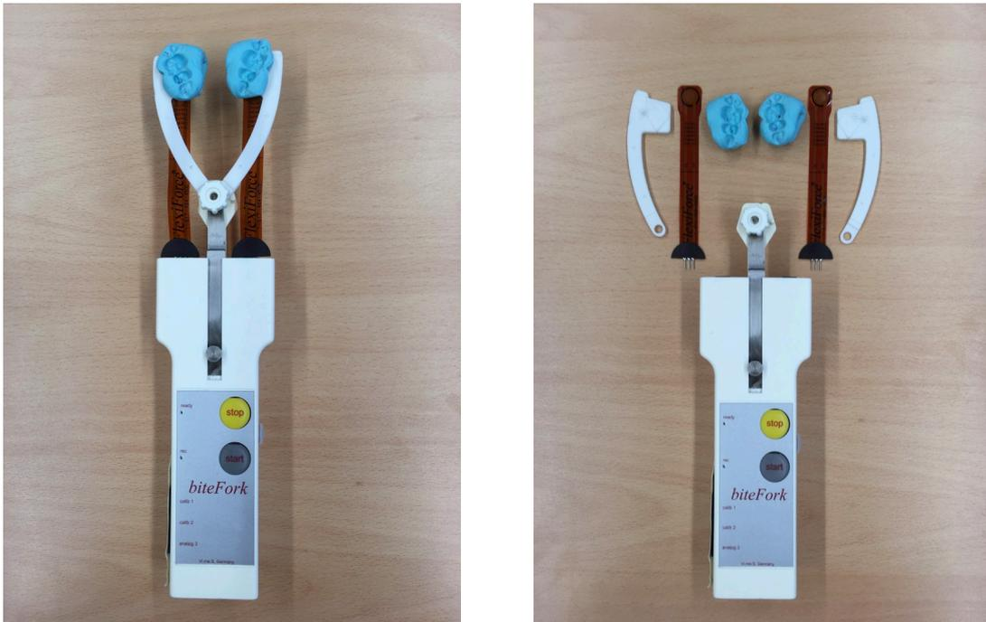
**Abb. 1: Aufbau des Messgerätes biteFork mit den Einzelteilen: Handstück, zwei Druckfoliensensoren, ein Sensorträgerpaar und die jeweiligen Einbisse aus Silikon.**
