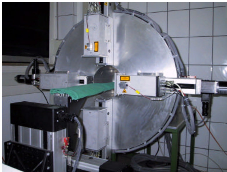
Abb. 5. TierPET. Die Kamera hat eine räumliche Auflösung von 2.1 mm und eine Sensitivität von 3.24 cps/kBq für einen Zentrum-Detektor-Abstand von 80 mm.
