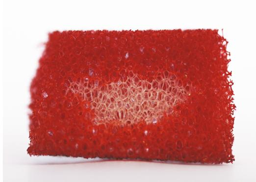
**Abbildung 20:** Halbierter PU-Würfel nach einer 24 h Fermentation von *P. putida* pig-r2. Im Innenkern des Würfels zeigt sich kein adsorbiertes Prodigiosin (**1a**).
