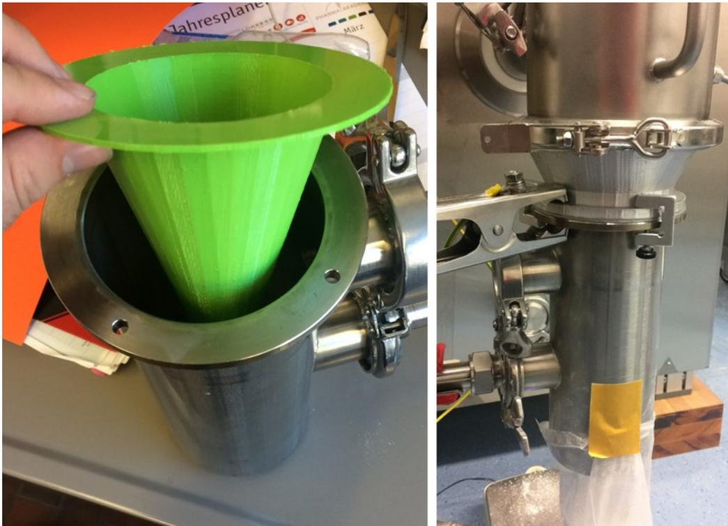
Abbildung 3.2.8. Fokussierung des Partikelstromes. Links: Erster Prototyp aus Polyactid, Rechts: Einbau mit Adapter am BRC25. Teile wurden mit metallischem Lack ableitfähig beschichtet. Trichterauslass  $d = 3 \text{ cm}$
