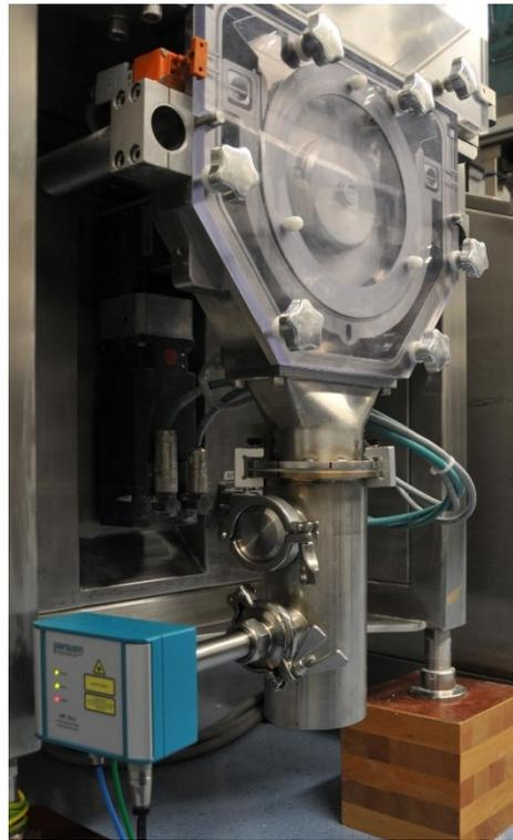
Abbildung 3.2.4. Konstruiertes Fallrohr mit installierter Sonde für den Gerteis Mini-Pactor, Einbautiefe A, Abstand zum Sieb ca. 30 cm
