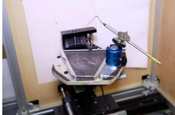
**Abb. 15: Arretierungsplatte auf dem Stativkopf**
