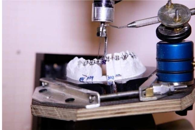
**Abb. 22: Arretierungsplatte mit eingespanntem Modell und Sonde**
