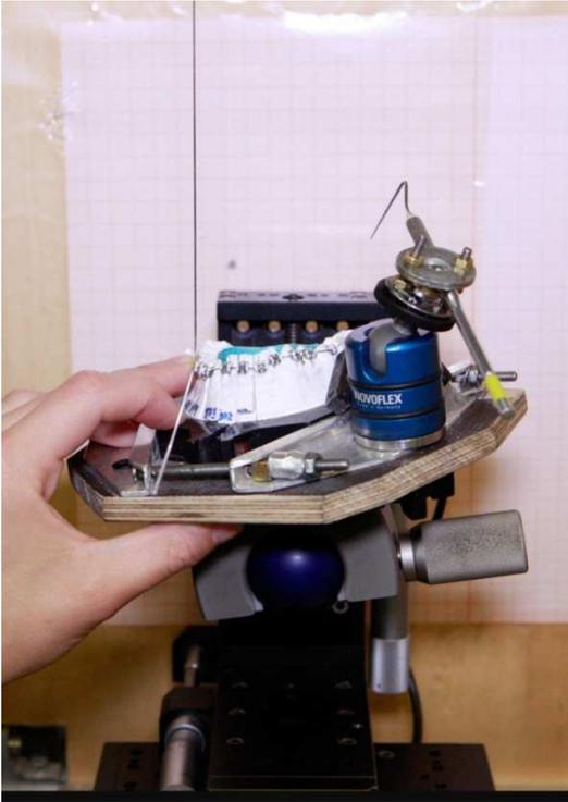
**Abb. 20: Messkreuz: Bogen im 90°-Winkel (17 x 25er Bogen) als Ausrichtungshilfe**
