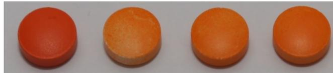
Abbildung 40: Bei der Vermessung mit der SPINE Maschine aussortierte Tabletten aus Versuch O1, die farbliche Unterschiede aufweisen
