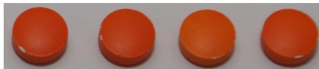
Abbildung 41: Bei der Vermessung mit der SPINE Maschine aussortierte Tabletten aus Versuch O1 mit beschädigten Kanten
