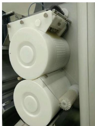
Abbildung 45: Walzen der SPINE Maschine und Linienkameras
