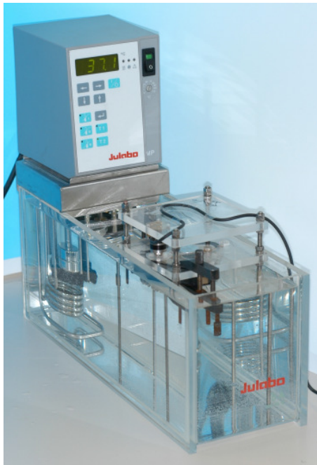
Abb. 16: Versuchsaufbau stehend im Wasserbad bei 37,1°Celsius
