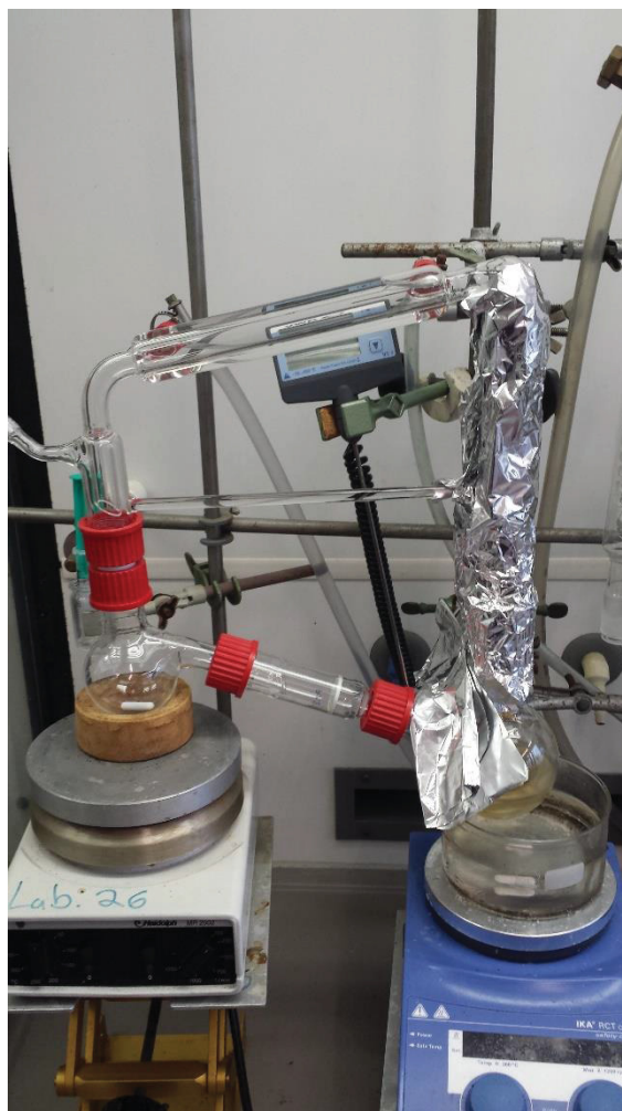
Abbildung 63: Leere Apparatur zum Austausch des Lösungsmittels von Metallogelen. Im linken Kolben befindet sich das Metallogel im Probenkorb, im rechten Kolben befindet sich das auszutauschende Lösungsmittel. Das Lösungsmittel wird im rechten Kolben zum Rückfluss erhitzt.
