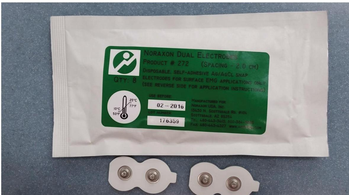
Abbildung 2: Hier verwendete bipolare Oberflächenelektroden der Firma Noraxon
