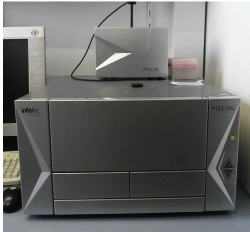
Abbildung 16: Photometer zur Messung der Absorptionswerte der Gewebeproben.
