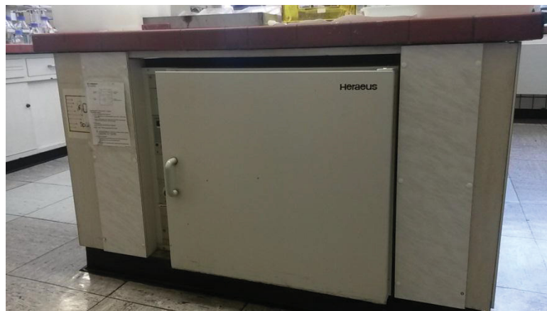
Abbildung 12: Inkubator zum Trocknen der Gewebeproben.
