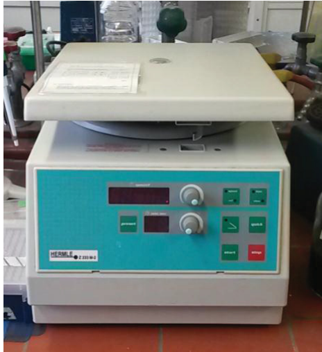
Abbildung 14: Mikroliterzentrifuge zum Zentrifugieren bei 10\,000 \times g .
