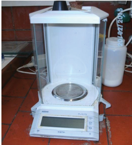
Abbildung 13: Analysewaage zur Bestimmung des Trockengewichts der Spezimen.
