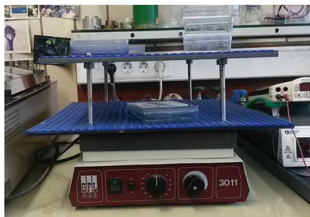
Abbildung 15: Taumel-Schüttler zur Ausbildung eines GAG-Färbemittelkomplexes.
