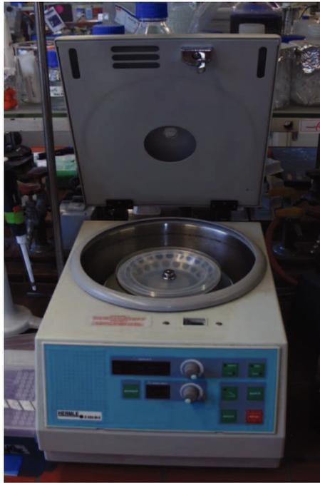
Abbildung 10: Mikroliterzentrifuge (Zentrifuge Z233 M-2, Hermle Labortechnik GmbH, Wehingen, Deutschland).
