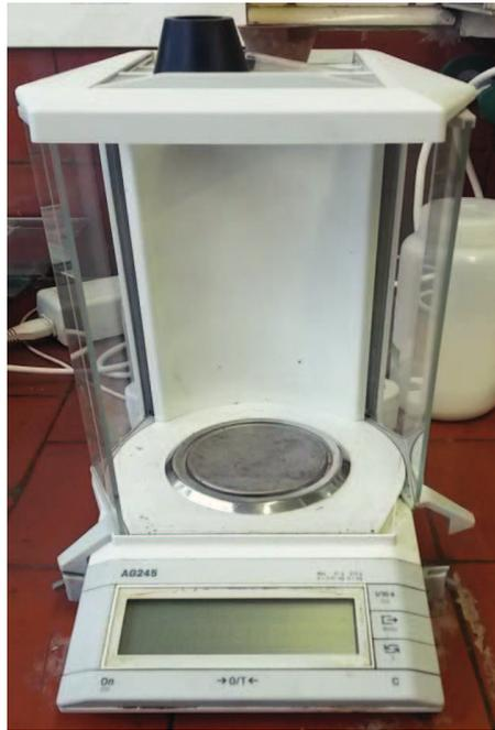
Abbildung 9: Analysewaage (Mettler Toledo, Greifensee, Schweiz).
