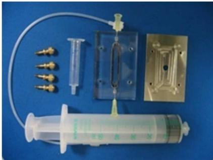
Abb. 4: Strömungskammer mit Perfusorspritze und Schlauch\*
