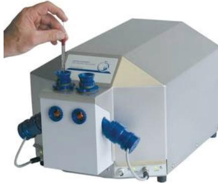
**Abbildung 2.3** Der Oxygraph-2K. Quelle: [http://www.orooboros.at/?Protocols\\_titrations](http://www.orooboros.at/?Protocols_titrations) (vom 07.08.2015)
