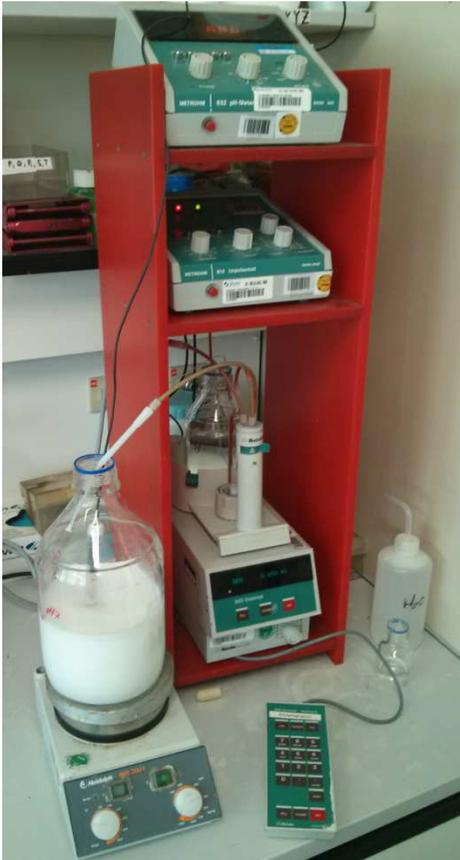
**Abb. 70:** Ganzzellumsetzung an einem Titriino der den pH-Wert bei konstant 7,1 hielt.
