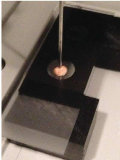
Abbildung 10 Fibersondenspitze direkt an der Tumorprobe (hier für das Foto mit Umgebungslicht)
