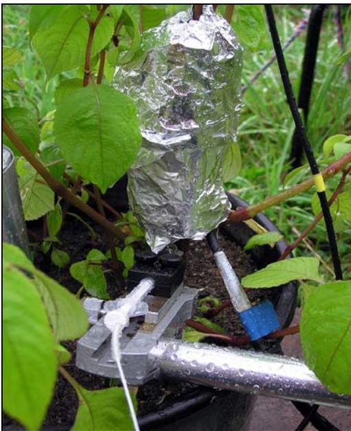
**Abb. 69:** Messungen des Xylem-Saftflusses (von Aluminiumfolie umhüllte Saftfluss-Manchette, oben) und der O<sub>2</sub>-Konzentration in den Sprosshohlräumen (mittels Spritzenkanüle applizierte Optode; unten) bei *I. balfourii*.
