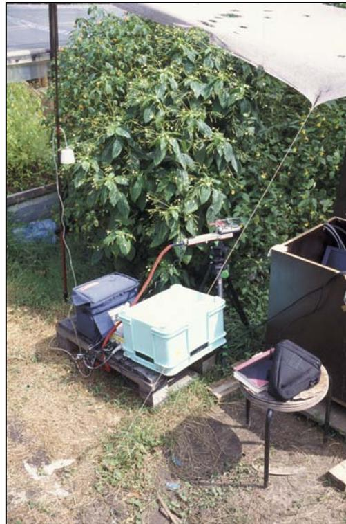
**Abb. 28:** LCA-4 Porometer bei Blattgaswechselformen an *I. parviflora*.
