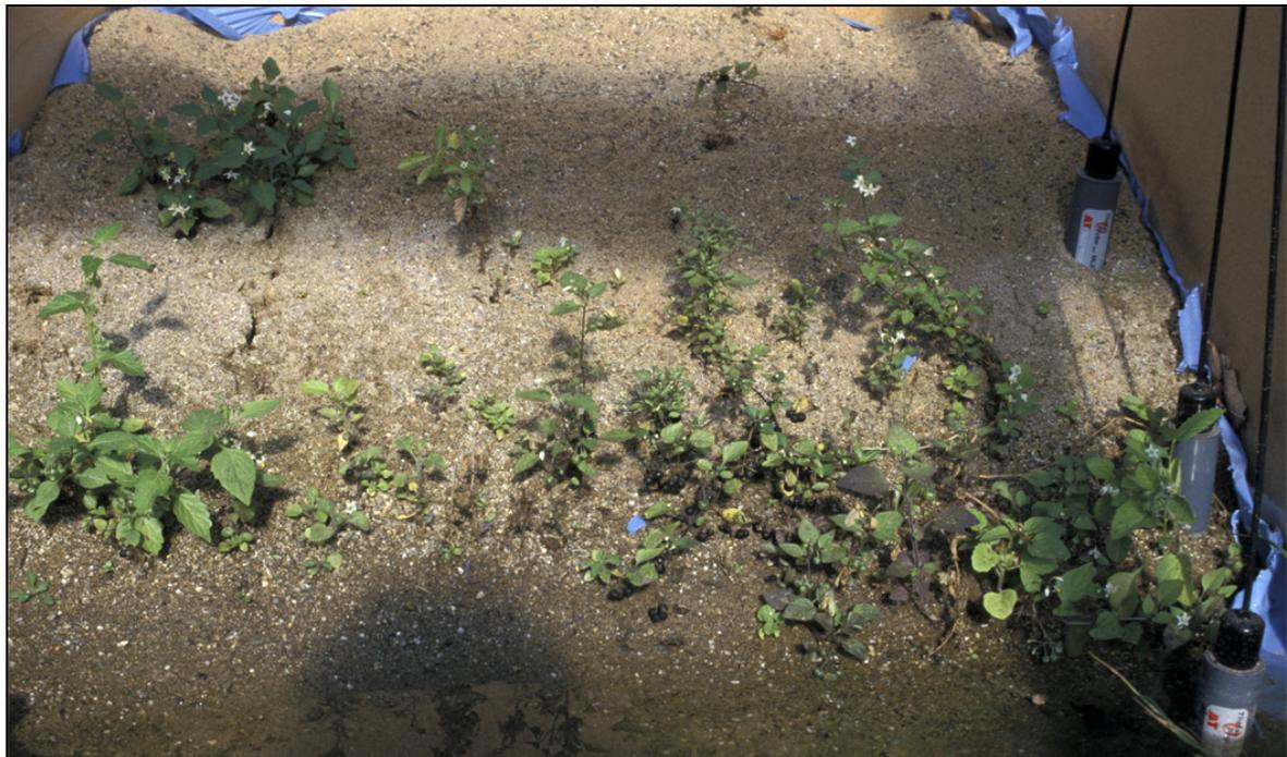
**Abb. 41:** Grundwasser-Gradientenbeet nach dem Hohenheimer Modell mit den beprobten *Solanum*-Arten (Konkurrenzversuch) zwei Monate nach der Aussaat (rechts TDR-Sensoren zur kontinuierlichen Erfassung der Bodenfeuchte).
