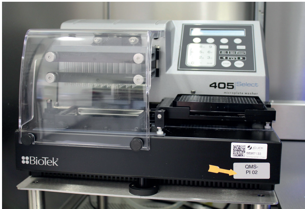
Abbildung 2.1: BioTek Washer 405 Select LS Washer mit Waschkamm, Mikrotiterplatten-Träger und Touchpad.
