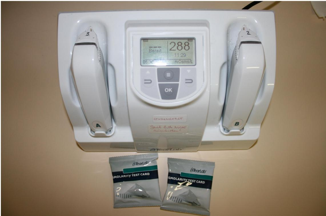
**Abbildung 8: Tear Lab Osmometer System**
