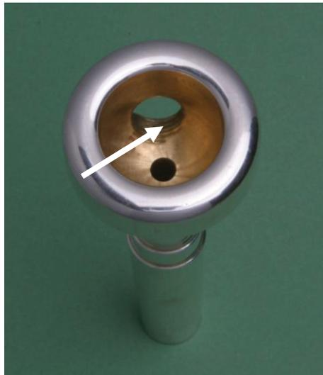
**Abb. 21: Trompetenmundstück mit eingefrästem Feingewinde (Pfeil)**
