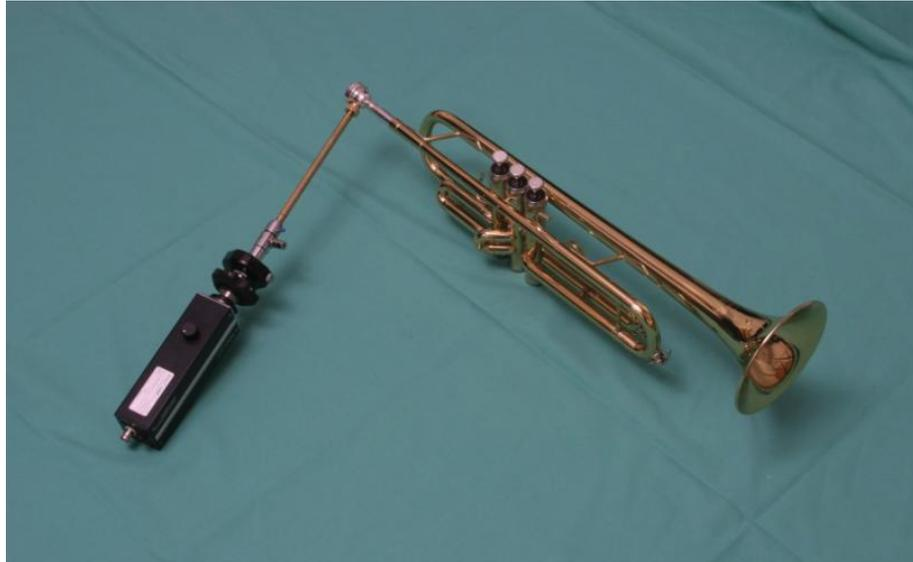
**Abb. 25: Mundstück mit daran fixierter Kamera-Endoskop-Einheit und angesetzter Trompete**
