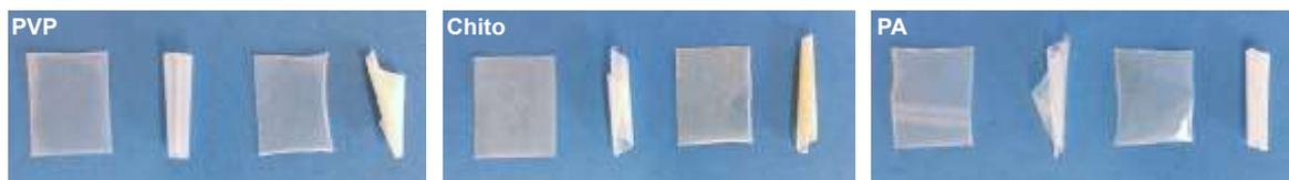
Abbildung 3.29: Visuelle Bewertung der Dreischichtfilme (3 cm<sup>2</sup>) PVP, Chitosan und PA nach 3 Monaten Lagerung bei 21 °C/45 % r.F. in Aluminiumsachets und offen in Glasbehältern sowie bei 40 °C/75 % r.F. in Aluminiumsachets und offen in Glasbehältern (von links nach rechts)
