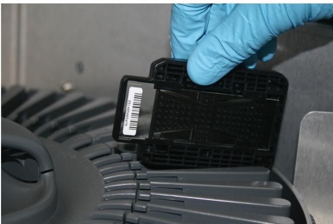
**Abb. 8:** Einlegen des Scan-Einsatz mit dem Microarray in das Scan-Gerät
