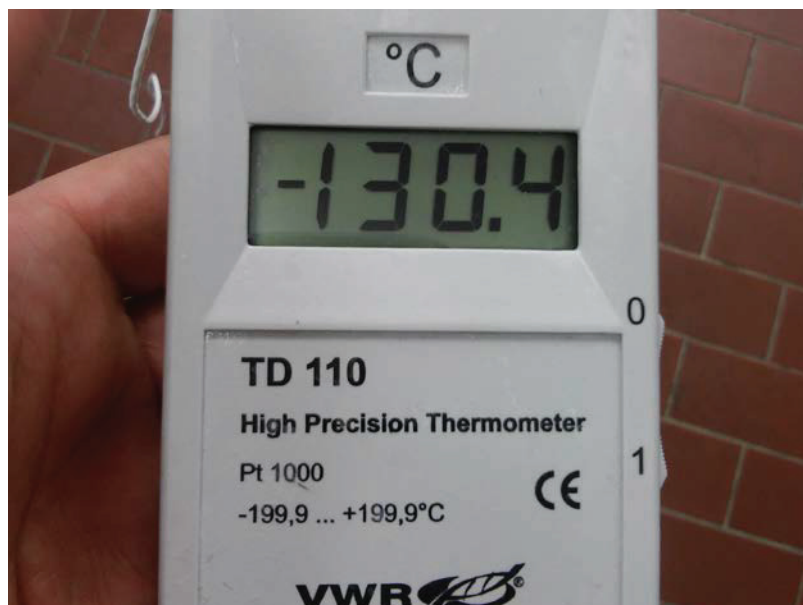
Abbildung 18 Temperatur des Pentan-Eisschlammes in ^{\circ}\text{C} .
