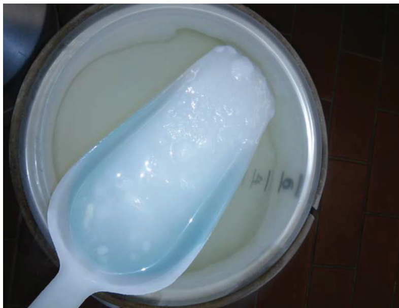
Abbildung 17 Bei -130\text{ }^{\circ}\text{C} entstandener Pentan-Eisschlamm.
