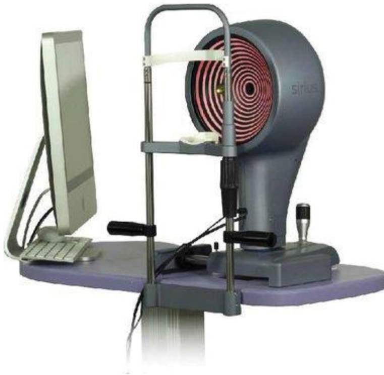
Abbildung 10: Sirius® (Fa. CSO) Scheimpflugkamera mit Placido-Scheibe. (Quelle: Bon Optikgeräte GmbH)
