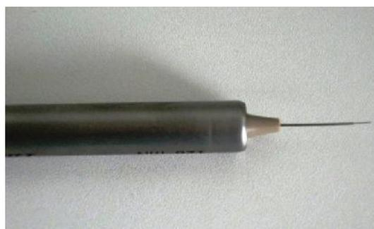
**Abbildung 3.11:** Pinprick-Stimulator (MRC Systems GmbH, Heidelberg, Deutschland) zur Testung der Mechanischen Schmerzschwelle.
