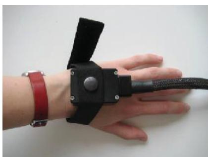
**Abbildung 3.9:** ATS-Thermode (MEDOC, Ramat Yishai, Israel) zur Applikation der Testtemperaturen.
