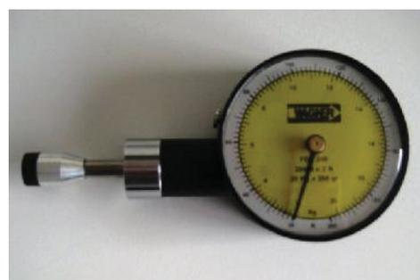
**Abbildung 3.14:** Druckalgometer (Force Dial, Wagner Instruments, Greenwich, CT USA) zur Testung der Druckschmerzschwelle.
