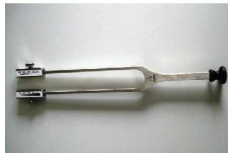
**Abbildung 3.13:** Rydel-Seiffer-Stimmgabel zur Bestimmung der Vibrationsdetektionsschwelle (Medizintechnik KaWe, Kirchner und Wilhelm GmbH & Co. KG, Asperg, Deutschland).
