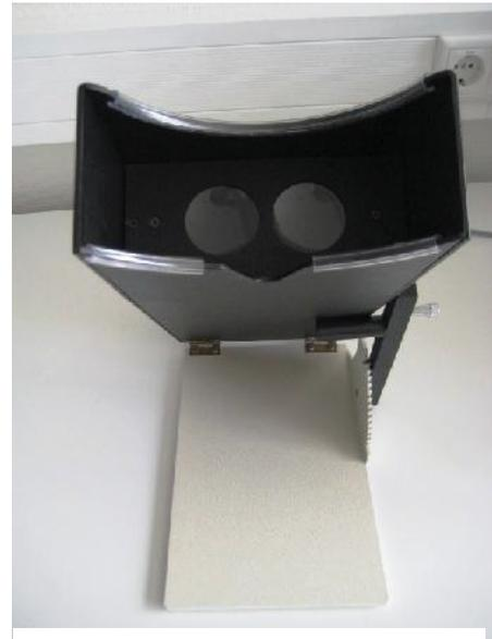
**Abbildung 3.1:** Flimmertubus zur Analyse der Kritischen Flimmerfrequenz (Eberhard 1994).
