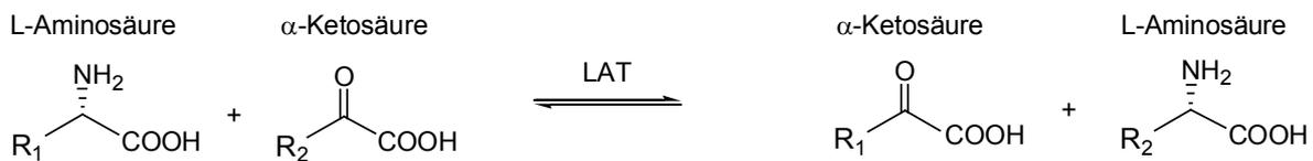
Schema 4: Reaktionsschema der L-Aminosäure-Transaminase (LAT) beim reversiblen Transfer der Aminogruppe einer L-Aminosäure (Amino-Donor) zu einer Ketosäuren (Amino-Akzeptor)
