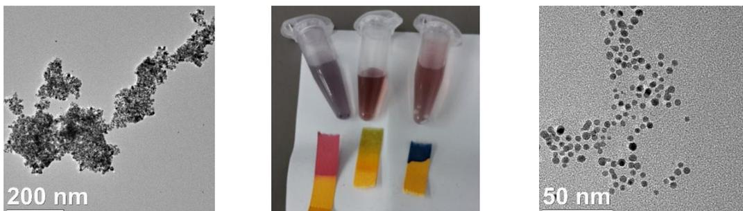
Abb. 4.45: links: TEM-Aufnahmen der Nanopartikel **12b AuNP** im sauren Milieu. mitte: Färbung der Nanopartikellösung im sauren Milieu (violett) und im neutralen bzw. basischen Bereich (rot). rechts: TEM-Aufnahmen der Nanopartikel **12b AuNP** im basischen Milieu.
