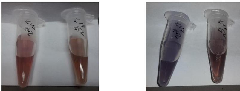
Abb. 4.46: Nanoparticuläre Lösungen von **14b AuNP** (KVP 142) und **12b AuNP** (KVP 152) vor der Zugabe der 5molaren HCl Lösung (links). Nanoparticuläre Lösungen von **14b AuNP** (KVP 142) und **12b AuNP** (KVP 152) nach der Zugabe der 5molaren HCl Lösung (rechts).
