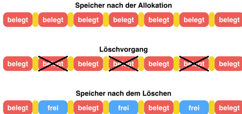
Abbildung 5.5: Worst-Case-Szenario für die Defragmentierung. Nach der Allokation wird jedes zweite Objekt gelöscht.
