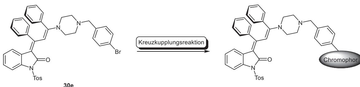
**Schema 5-40.** Die selektiv adressierbare Bromfunktionalität als Ausgangspunkt für den Aufbau oxindol-merocyaninbasierter Bichromophore.
