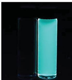
**Abbildung 5-106.** Emissionsverhalten der Verbindungen **37a** (links) und **37b** (rechts) in  $\text{CH}_2\text{Cl}_2$  UVASOL<sup>®</sup> bei UV-Bestrahlung mit einer handelsüblichen UV-Lampe ( $\lambda_{\text{exc}} \sim 365 \text{ nm}$ ).
