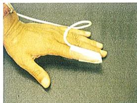
**5.** Fingersensor festkleben (Kabel muss über dem Finger liegen)
