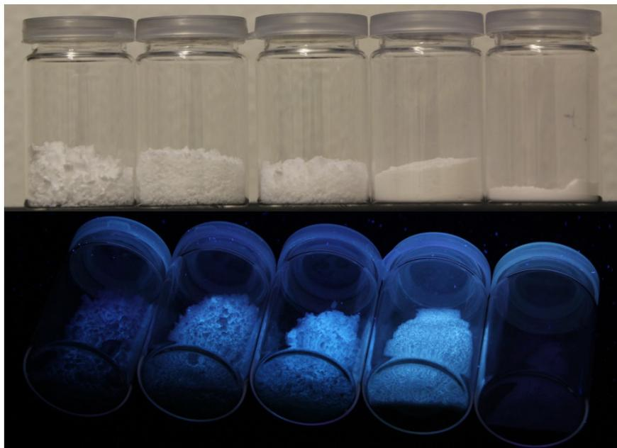
**Abbildung 4.32** Amorphes nanoclusterdotiertes  $\text{SiO}_2$ , hergestellt über ein zweistufiges Sol–Gel–Verfahren mit säurekatalysierter Hydrolyse und basenkatalysierter Kondensation vor dem Tempern. Fotos unter Tages– (oben) und UV–Licht (unten). Das Verhältnis des Volumens der AHS–AuNC–Lösung in Diethylenglycoldimethylether zu TEOS variiert von links nach rechts (1:8, 1:4, 3:8, 1:2,  $\text{SiO}_2$ –Referenz).
