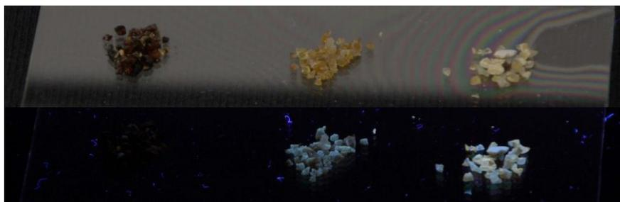
**Abbildung 4.30** Quarzgläser hergestellt über einen säurekatalysierten Sol–Gel–Prozess im Verhältnis TEOS : Wasser (1:1) nach dem Tempern nach 3 h, 5 h und 8 h von rechts nach links. Fotos unter Tages– (oben) und UV–Licht (unten).
