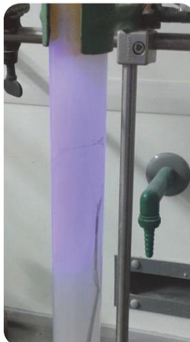
**Abbildung 56:** Fotografie der säulenchromatographischen Aufreinigung von Verbindung **4a** (unter UV-Lampe  $\lambda = 365 \text{ nm}$ ).
