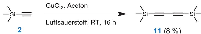
**Schema 57:** Versuch zur Homokupplung von TMSA.<sup>[260]</sup>
