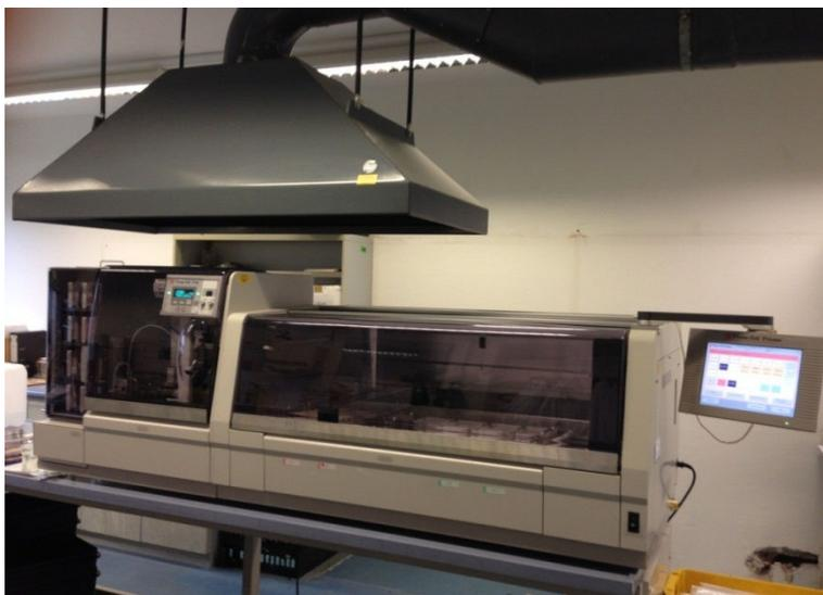
**Abb. 4:** Färbeautomat am Schwerpunkt für Cytopathologie für automatisierte und standardisierte zytologische Färbungen.
