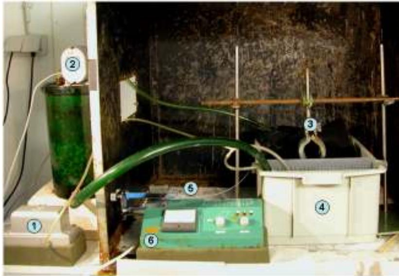
Abb. 2.11: Darstellung des Versuchsaufbaus zur Bestimmung von Dopamin, Octopamin und Serotonin aus der Hämolymphe von *Homarus americanus*. 1: Luftzufuhr, 2: Filterpumpe, 3: Klammer, 4: Versuchsbecken, 5: Infusionskatheter mit Spritze 6: Perfusor.
