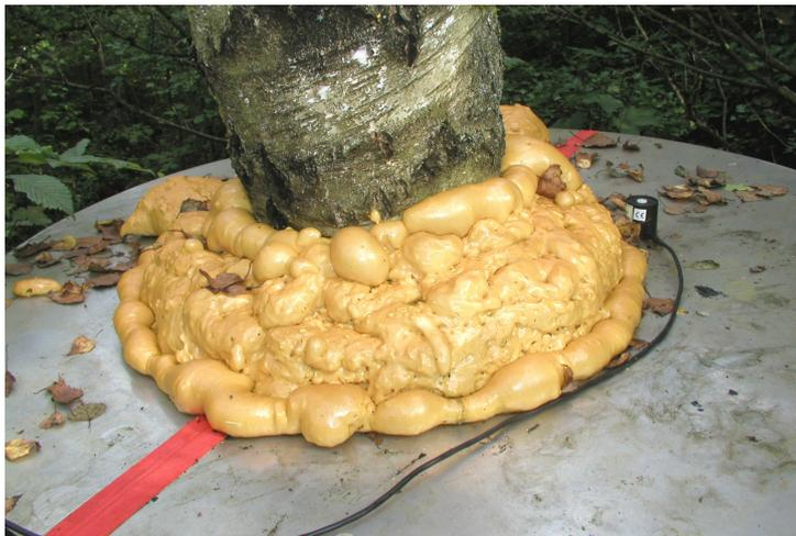
Abbildung 27: Neue Abdeckung des Begasungszylinders. Durch eine Gummidichtung und durch die glatte Oberfläche des Aluminiumdeckels wird eine Abdichtung des Zylinders auch dann erreicht, wenn der Baum durch Windböen bewegt wird.
