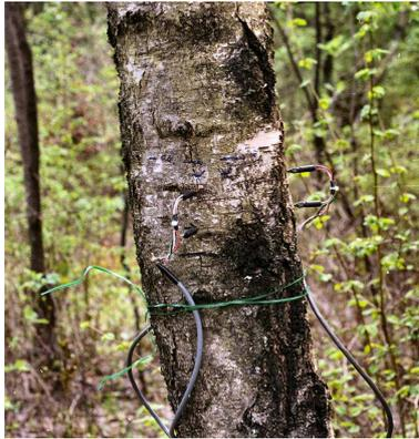
*A: Installation der Granier- Sensoren im 120° Winkel*
