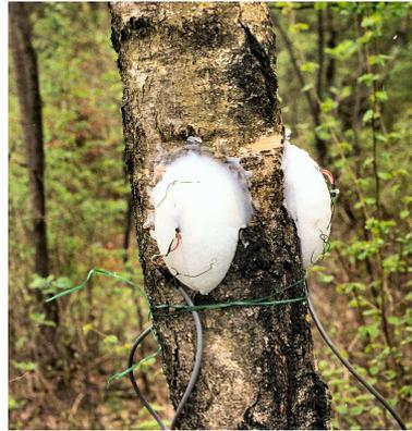
*B: Montage und Abdichtung der Styropor-Isolation*
