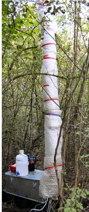
Abbildung 19B: Stamm von Baum 8, mit Luftkissenfolie isoliert, vor der Bohrkernentnahme
