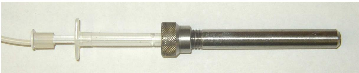
Abbildung 25: Optodenhalterung zum Einschlagen in Xylem und Rindengewebe nach vorheriger Bohrung zusammen mit eingeführter Optode samt Spritzengehäuse. Bei der Applikation am Baumstamm wird die Spritzenkanüle 1 cm über das Ende der Edelstahl-Applikationseinheit montiert und die Glasfaser mindestens 5 mm weit in den ins Xylem gebohrten Hohlraum ausgefahren.
