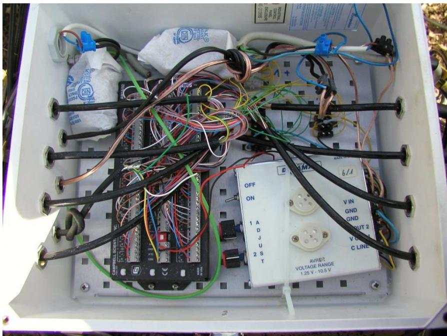
Abbildung 18: Multiplexereinheit AM16/32 mit Spannungsregulator AVRDC und Anschlusskabel für maximal acht Mehrpunkt-Graniersensoren. Silicagel in den oben sichtbaren Beuteln bindet Feuchtigkeit und verhindert so die Korrosion der elektronischen Geräte. Die Abwärme des Spannungsregulators wirkt zusätzlich kondensationsmindernd.
