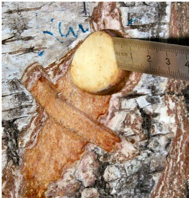
Abbildung 23: Vorbereitung des Birkenstammes zur Montage der LiPAX-Kammer direkt auf dem Kambium. Die seitlich abstehenden Sensoren erfordern je nach Stammgeometrie ein partielles Abtragen der Borke.
