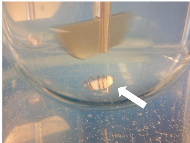
**Abbildung 36: Verklebte Soluplus® Granulatpartikel (mit Carbamazepin als Arzneistoff) nach Auflösen der Kapselhülle (2h nach Start der Freisetzung).**
