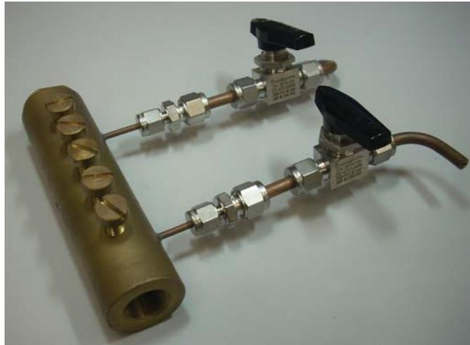
Abbildung 1.3: Eine der entwickelten photoakustischen Messzellen mit verschiedenen Möglichkeiten der Einbringung des Mikrofons (Schraubverschlüsse auf der Oberseite)
