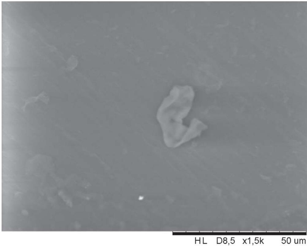
Abbildung 4.21: Elektronenmikroskopische Aufnahme einer Inhomogenität, 15kV
