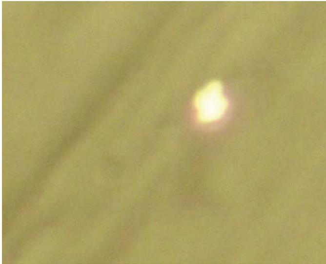
Abbildung 4.19: Inhomogenität in einer Isolationsprobe, 1250x
