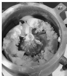
Abbildung 57: Aufsicht auf das Pulverbett im Schnellmischer nach der Schmelzgranulierung von 80 % Ibuprofen mit SiO 2 -Zusatz und 20 % Hartfett (Rührgeschwindigkeit 800 rpm, Manteltemperatur 38 °C, Schmelzverfahren).
