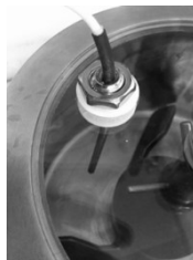
Abbildung 76: Temperaturfühler, angebracht am Deckel des Mischbehälters
