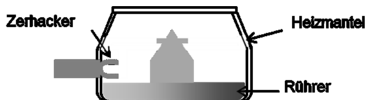
Abbildung 2: Schematische Zeichnung des Diosna P-VAC 10 Schnellmischers
