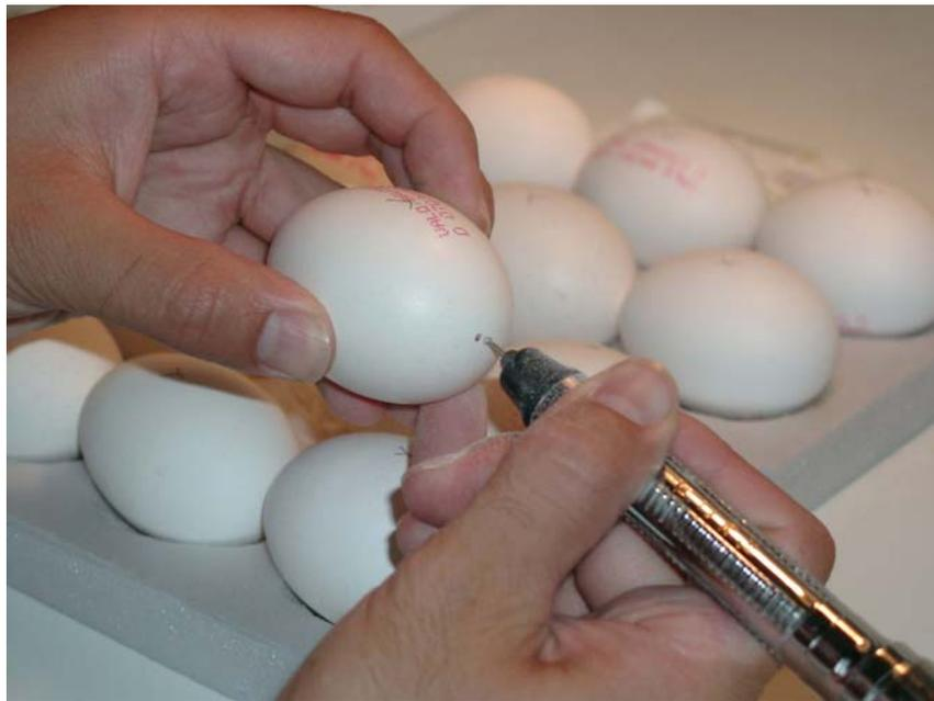
*Abb. 9: Anbohren des Hühnereies mit Hilfe einer Welle und eines 1,6 mm Rosenbohrers bei  $20.000 \text{ min}^{-1}$*
