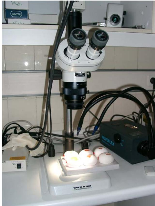
Abb. 13: Auflichtmikroskop mit Kaltlichtquelle und Videokamera
