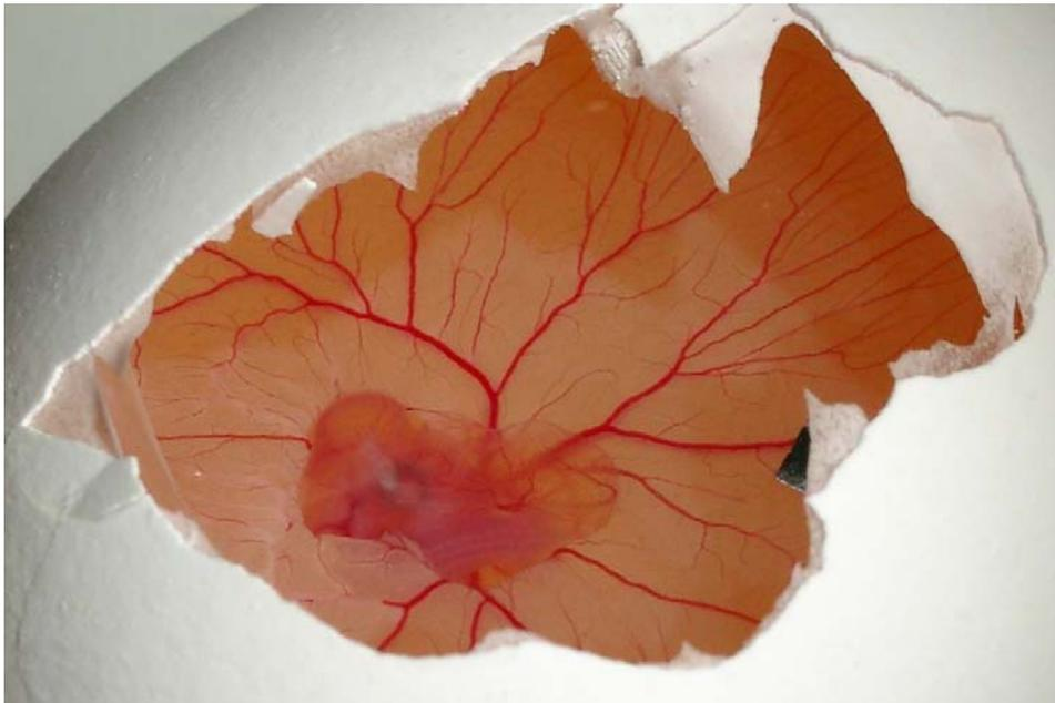
Abb. 15: Keimling mit aufgelegter Ni-Ti-Folie 48 h nach Applikation des Teststoffes (5. Bebrütungstag) Rechts ist der Testkörper auf dem DGS zu erkennen..
