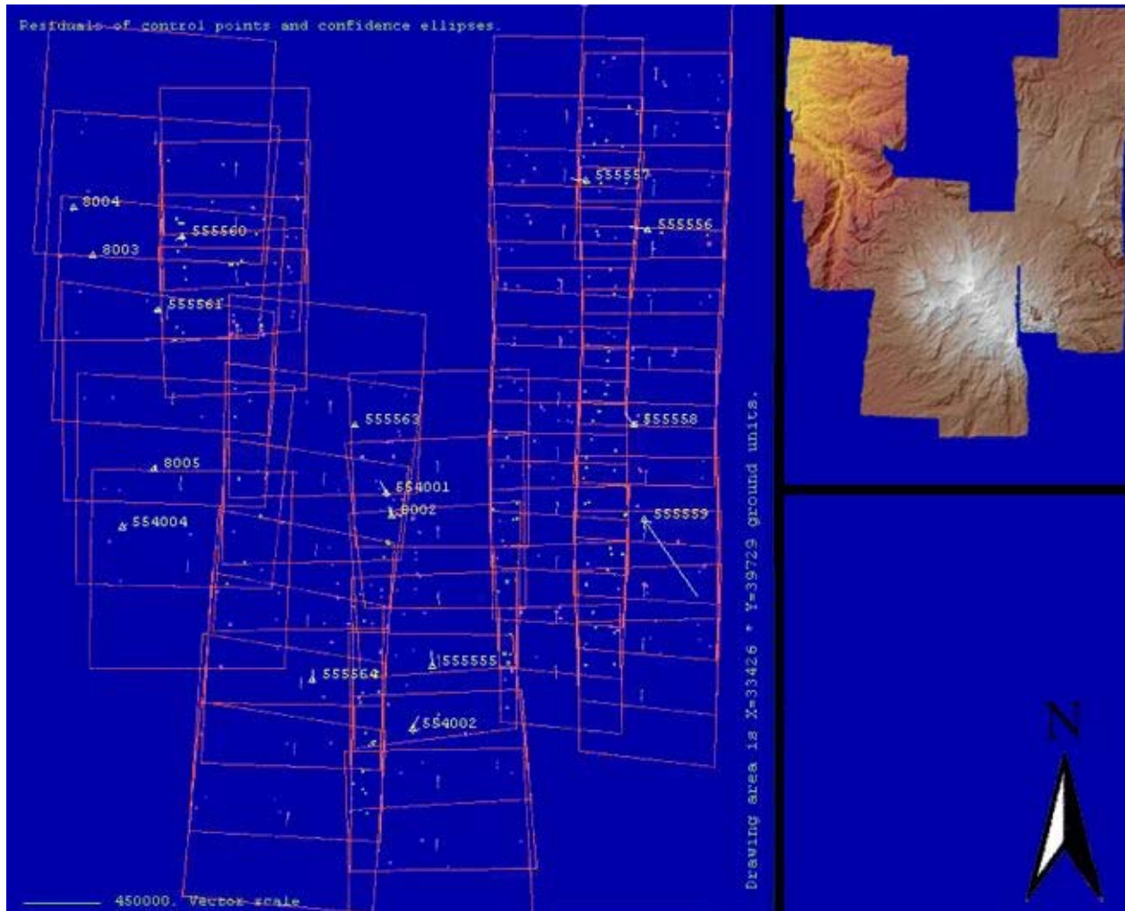
Abbildung 3.3: Lage der genutzten Passpunkte in den für die Aero triangulation genutzten Befliegungsstreifen.
