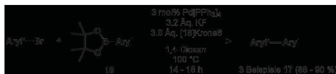
Schema 3.3-19: Suzuki -Kreuzkupplung zum Aufbau der Donorfragmente 17a-c .
