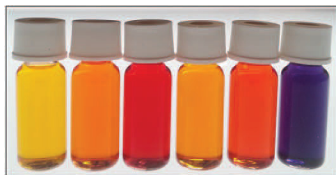
Abbildung 3.3-34: Fotografie, Akzeptor-substituierte Phenothiazin-Merocyanine H-VI-a , -b , -e , -f , -h , -k (v.l.n.r.) in Dichlormethan ( c = 20^{-3} \text{ M} ), bei Tageslicht.
