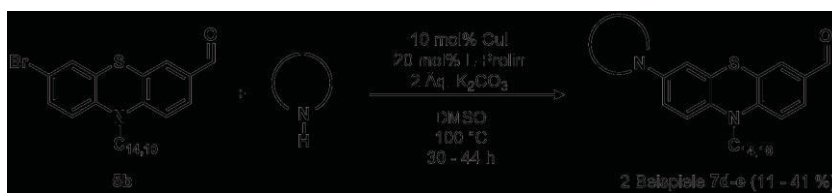
Schema 3.3-6: Ullmann -Aminierung zur Darstellung der Donor-substituierten Phenothiazin-3-carbaldehyde 7d-e .
