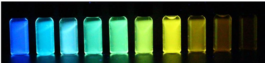
Abbildung 25. Fluoreszenz des 3-Ethynylchinoxalins **5j** in Abhängigkeit der Lösungsmittelpolarität. (von links nach rechts: Cyclohexan, Toluol, THF, Ethylacetat,  $\text{CH}_2\text{Cl}_2$ , Aceton, Acetonitril, Isopropanol, Ethanol, Methanol;  $T = 293 \text{ K}$ ,  $c(\mathbf{5j}) = 10^{-5} \text{ M}$ ,  $\lambda_{\text{ex}} = 356 \text{ nm}$ ).
