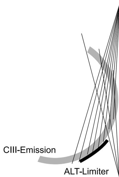
**Abbildung 5.15.:** Die CIII-Emission ist in einer dünnen Schale direkt innerhalb der letzten geschlossenen Flußfläche lokalisiert.
