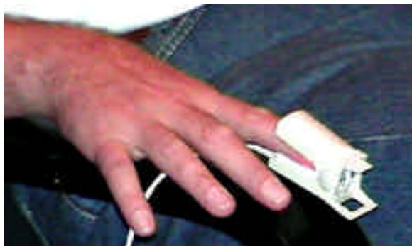
Abb. 5: Position des Pulsoximeter zur Erfassung der Fingerpulsamplitude
