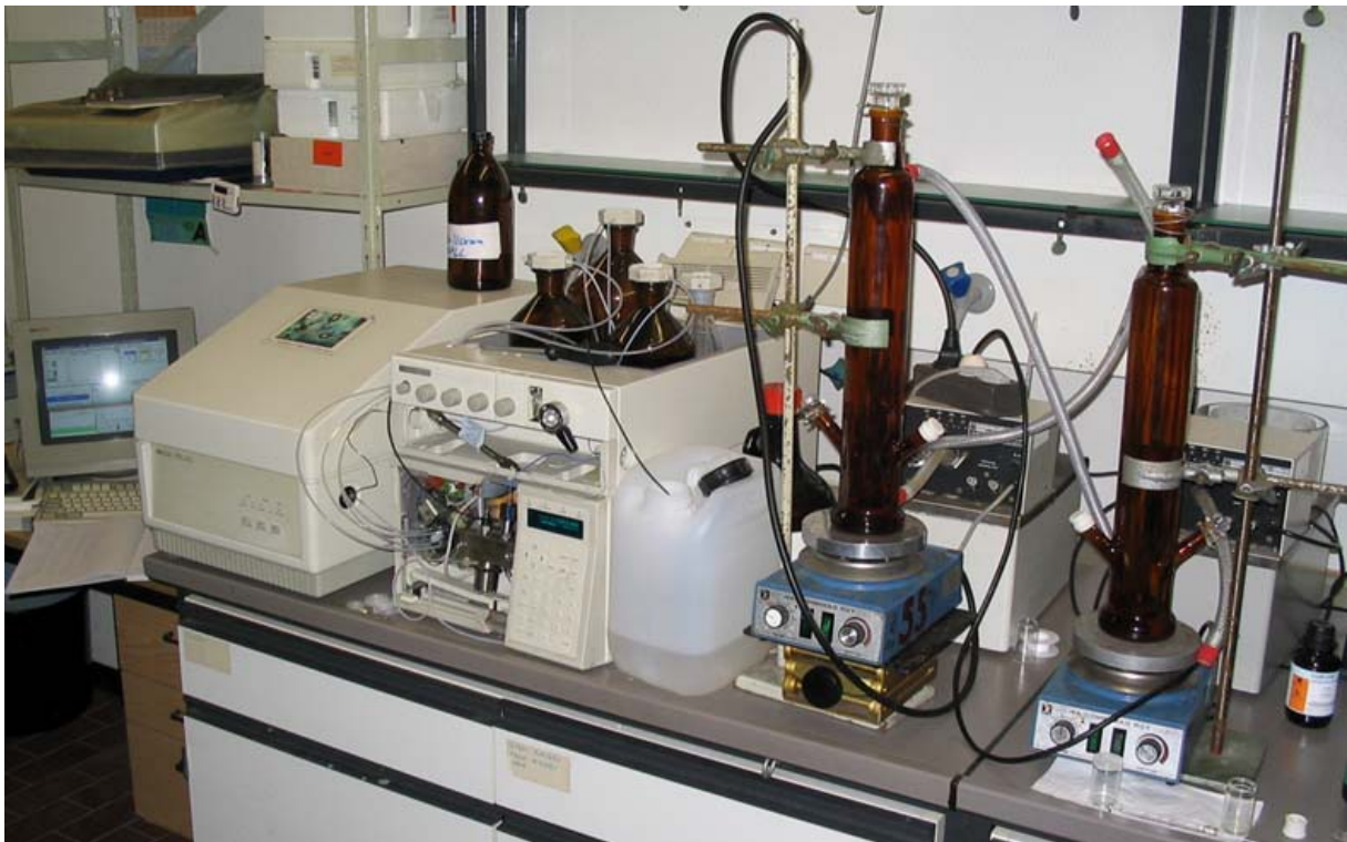
Abbildung 4-1: Messapparatur mit DAD-Detektor, Pumpe mit Mischbatterie, Reaktionsgefäße mit Thermostat im Hintergrund
