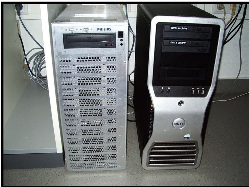
Abb. 4: iDose<sup>®</sup>-Prototyp-Hardware mit Rekonstruktionsrechner (links) und Bedienungsrechner (rechts).
