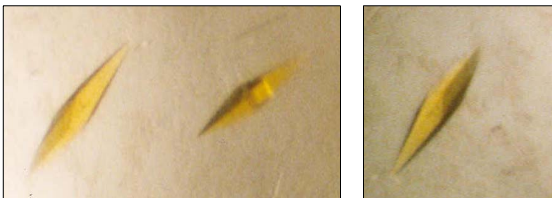
Abb. 34: Tetragonale NOX-Kristalle, Bedingungen: 34 % PEG MME 2000, 15 % Glycerin, 0,1 M Na-acetat, 0,2 M Ammoniumsulfat pH 5,4, 19^\circ\text{C} , Kristallgröße: 0,1 \text{ mm} \times 0,1 \text{ mm} \times 0,45 \text{ mm} .
