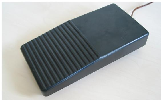
**Abb. 4.45.:** Fußpedal zur Auslösung des virtuellen Röntgenvorgangs.
