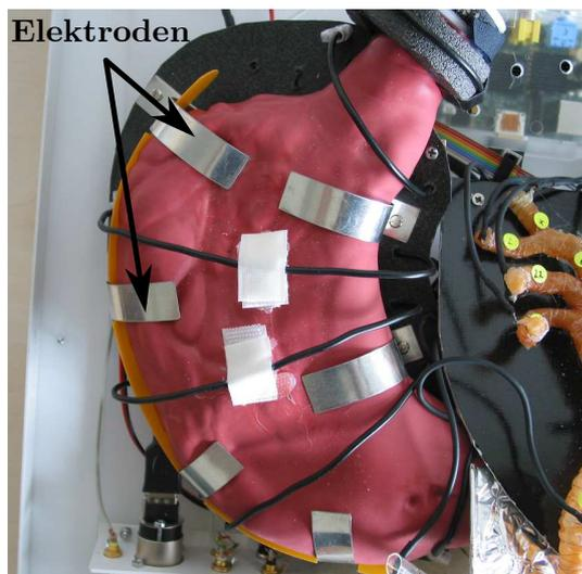
**Abb. 4.47.:** Elektroden auf der Magenoberfläche, vier an der großen und zwei an der kleinen Krümmung.
