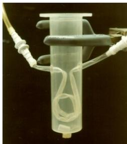
Ein durch den Schlauch durchgezogener Metalldraht sorgt für den Halt des Schlauches. Durch den Schlauch wird nun Sauerstoff geleitet, somit kann kontinuierlicher oder pulsweiser Sauerstoff in die Lösung diffundieren und die Reaktion mit Sauerstoff versorgen. Aufgrund der Dimension der Begasungsanlage musste der Ansatz in einem größeren Maßstab (8-10 mL) durchgeführt werden als der Standardansatz, der üblicherweise im (1-2)-mL-Maßstab ablief. Eingesetzt wurden:
